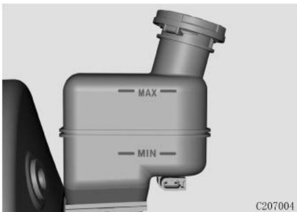
При низком уровне тормозной жидкости, добавьте тормозную жидкость до «MAX» (максимальной) отметки.
