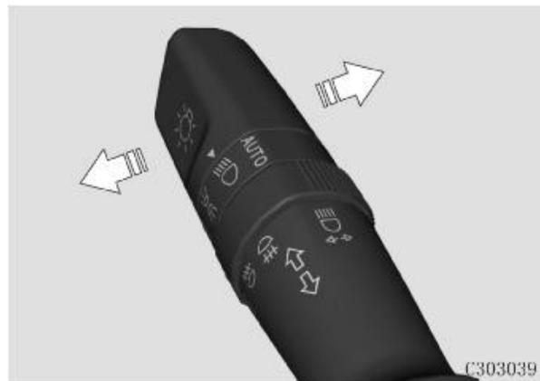
Поверните переключатель освещения в положение
