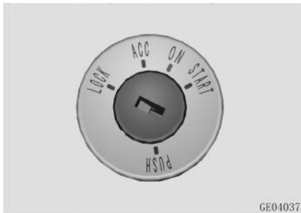
**LOCK** (Заблокировано): Зажигание выключено. Рулевая колонка блокируется после извлечения ключа.
