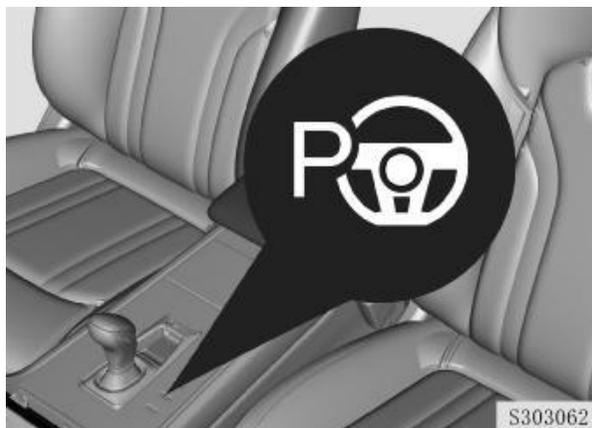
Автоматическая система помощи при парковке объединяет четыре функции: параллельная парковка, парковка задним ходом (перпендикулярная), диагональная парковка и парковка с помощью ключа дистанционного управления как изнутри, так и снаружи автомобиля.
