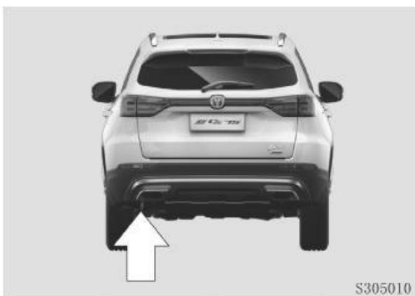
Задняя буксировочная петля расположена на лонжероне кузова, слева под задним бампером автомобиля.
