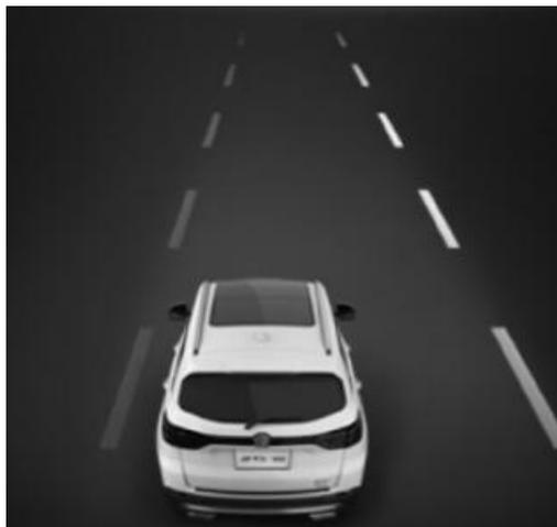
Отображает информацию об обнаружении линий разметки на полосе движения и информирует о непреднамеренном пересечении автомобилем линии дорожной разметки.
