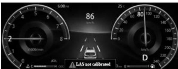
3. Неисправность системы оповещения о непреднамеренном пересечении дорожной разметки:
