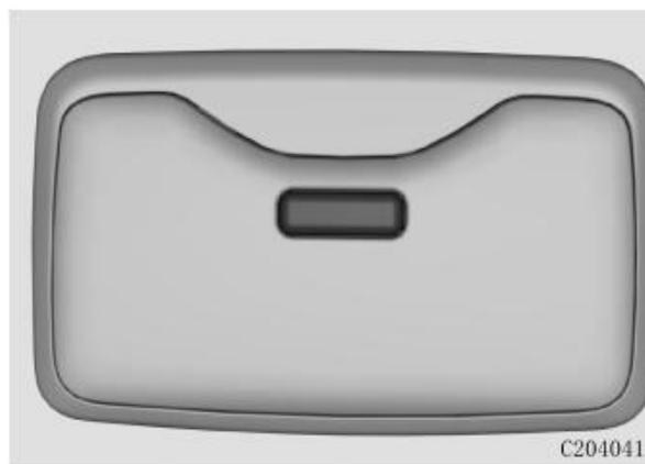
Для включения индивидуального освещения в задней части салона, нажмите на соответствующий выключатель. Повторное нажатие выключит индивидуальное освещение.
