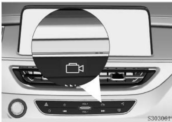
При включенном электропитании автомобиля (положение ON) и скорости автомобиля не более 27 Км/ч.
