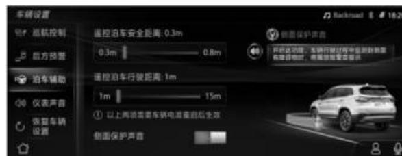
Пройденный путь автомобиля соответствует установленному расстоянию при движении вперед, которое автомобиль может пройти после настройки. Расстояние, установленное системой по умолчанию - 4м. В целях обеспечения безопасности работы системы, настройки будут доступны после перезапуска автомобиля.
