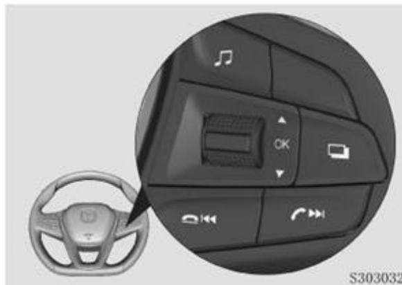
Комбинированный переключатель представляет собой четырехпозиционную кнопку на рулевом колесе.
