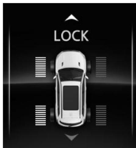
Во время движения автомобиля на дисплее отображается информация о распределении крутящего момента на четырех колесах и информация о режиме работы системы.
