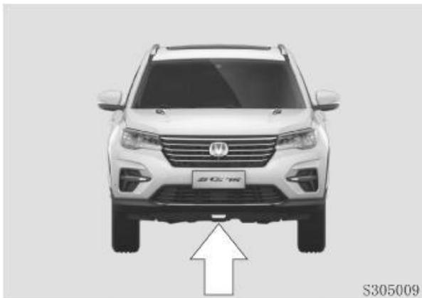
Передняя буксировочная петля расположена на переднем подрамнике под передним бампером автомобиля.
