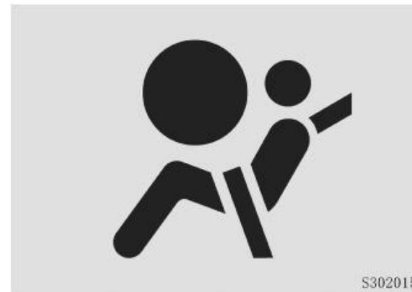
При включении зажигания (положение ON), индикатор системы SRS и подушек безопасности включится примерно на 3~6 секунды, а потом погаснет. При корректной работе системы индикатор выключен.
