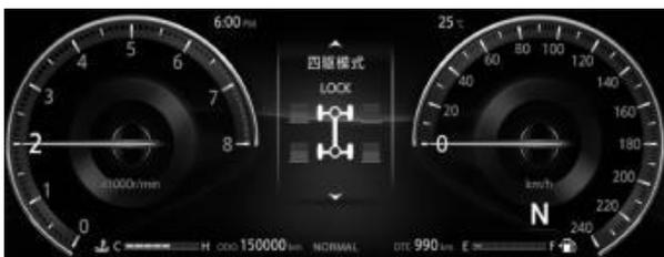
**AUTO (Автоматический) режим:** при движении автомобиля по дорогам общего пользования и вымощенным дорогам, используйте автоматический (AUTO) режим. В данном режиме поведение автомобиля не отличается от работы обычного моноприводного автомобиля при стандартных условиях движения. Однако, если система определит, что требуется режим полного привода, крутящий момент двигателя будет перераспределен на все четыре колеса без участия водителя.
