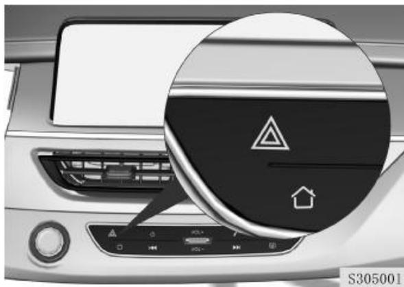
Кнопка включения световой аварийной сигнализации расположена на центральной консоли.
