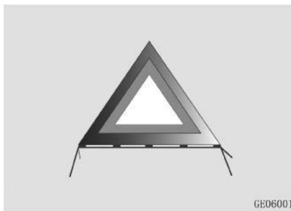
Знак аварийной остановки расположен в багажном отделении, в нише запасного колеса, с дорожным бортовым инструментом под ковром багажного отделения.
