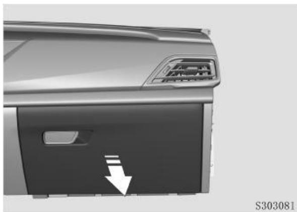
**Открывание:** потяните за ручку ящика. Крышка медленно опустится до полного открывания. Перчаточный ящик оборудован фиксатором для ручки и слотом для банковских и других пластиковых карт.
