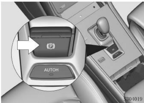
При снятии автомобиля со стояночного тормоза сначала нажмите на педаль тормоза, затем нажмите клавишу EPB. Стояночный тормоз разблокируется, и индикаторы погаснут.
