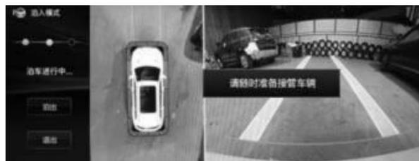
После остановки автомобиля на выбранном парковочном месте, система проинформирует пользователя об окончании парковки, автоматически переведет селектор в положение «Р» и установит автомобиль на стояночный тормоз.
