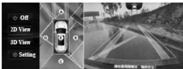
При переключении селектора АКПП из положения «R» в положение «D», изображение автоматически переключится с панорамного изображения + вид сзади на панорамное изображение + вид спереди.
