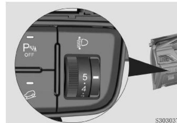
При изменении положения автомобиля, в зависимости от загрузки, ускорений, торможений и других условий, во избежание ослепления других участников дорожного движения, возможна регулировка уровня освещения ближнего света фар с помощью регулятора уровня. Прокрутите регулятор вверх, и уровень ближнего света фар поднимется на максимальный уровень (-->0, максимальное расстояние освещения); прокрутите вниз, и угол освещения фар опустится (-->5, минимальное расстояние освещения).
