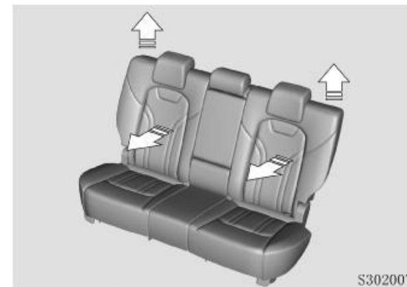
Поднимите рычаг фиксатора спинки. Отрегулируйте спинку под нужным углом (доступно два положения), а затем отпустите рычаг фиксатора.
