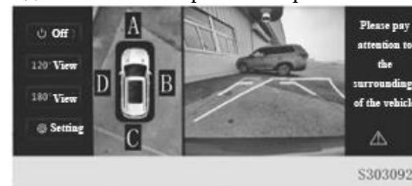
При переключении селектора АКПП из положения «R» в положение «D», изображение автоматически переключится с панорамного изображения + вид сзади на панорамное изображение + вид спереди.
