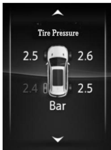
Отображает значение давления в шинах, и предупреждает о низком давлении в шинах.
