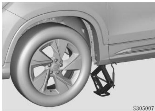
4. Снимите колесо и положите его рядом с автомобилем;
