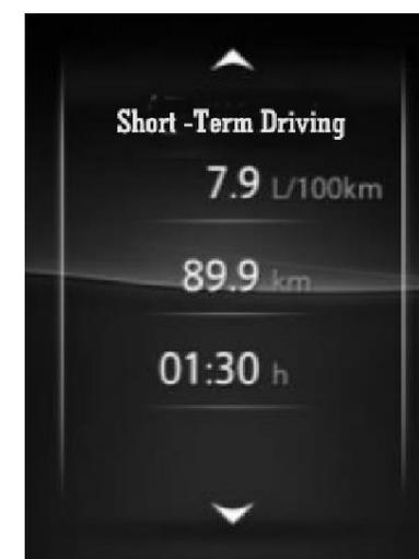
Отображает расход топлива, пробег и время текущей поездки.
