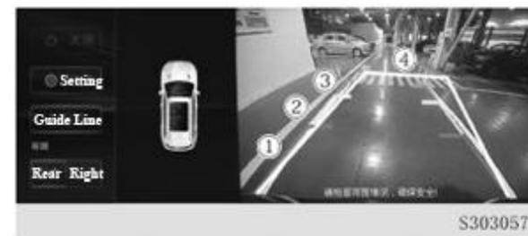
Вспомогательные линии на экране при парковке - двух видов: статические и динамические. Они отражают предполагаемую траекторию движения автомобиля на расстояние 3м по направлению назад от заднего бампера, по ширине, равной ширине автомобиля с наружными зеркалами заднего вида.
