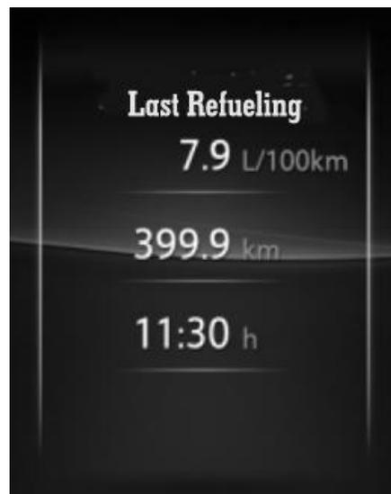
Отображает средний расход топлива, пробег и время от последней заправки до этой заправки.
