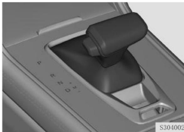
**«P» - парковка.** Положение «P» селектора АКПП – режим стоянки и запуска двигателя:
